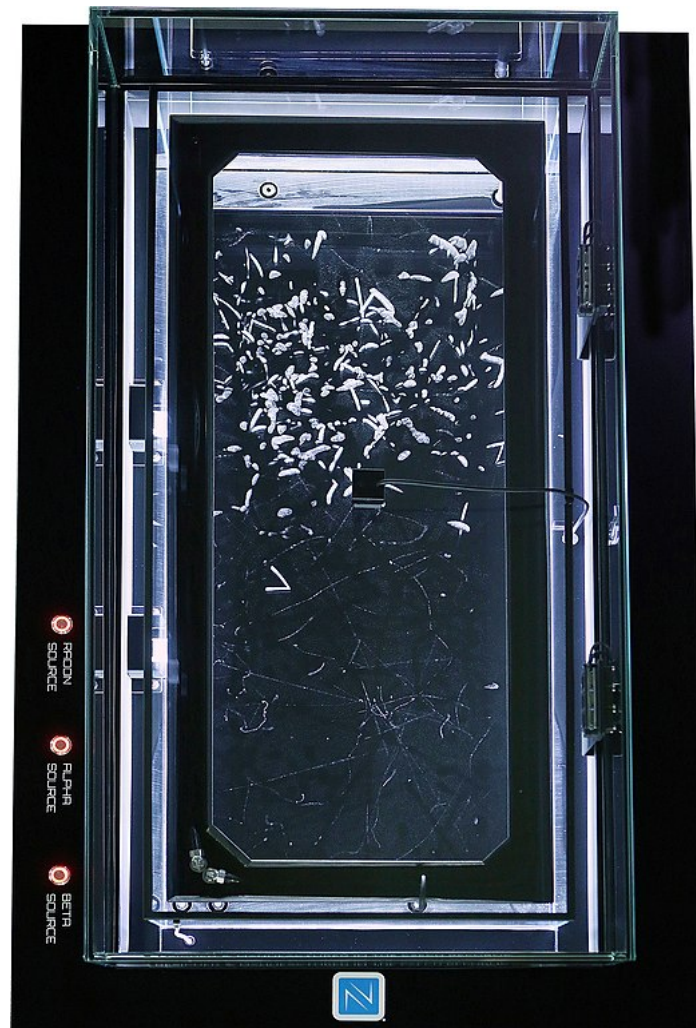
Kuva 7.8: Hiukkasten radat erottuvat sumukammiossa. Lyhyet paksut viivat ovat raskaampia hiukkasia ja ohuet pitkät kevyitä.
